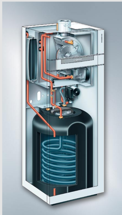
Vitodens 333-F (typ WR3C) 5,2 do 26,0 kW ze zintegrowanym, ładowanym przez węzownicę zasobnikiem c.w.u. (pojemność 130 litrów)
